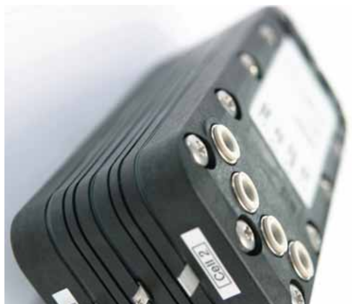
Abb. 3: EDI-Zelle mit einem maximalen Produktwasser-Fluss von 10 l / h
