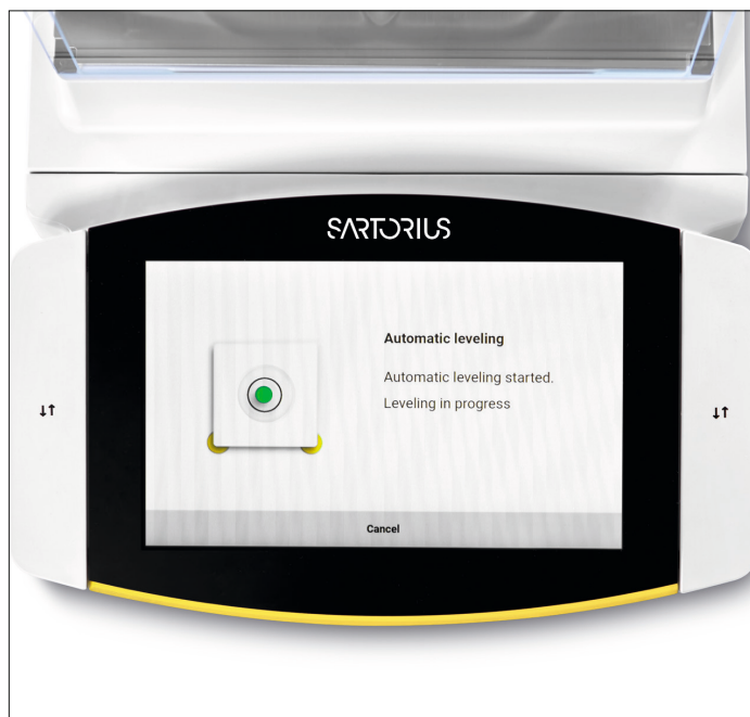
Abbildung 2: Vollautomatische Nivellierung bei Waagen der Cubis® Baureihe.
